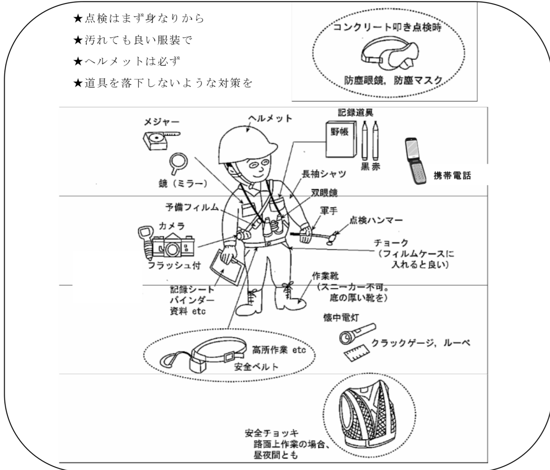
図 1.7.1 点検・調査に必要な持ち物と服装
