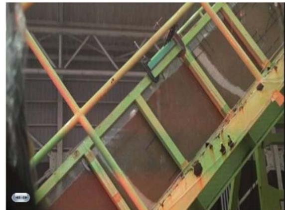
写真4 土層のせん断変形（側面）
