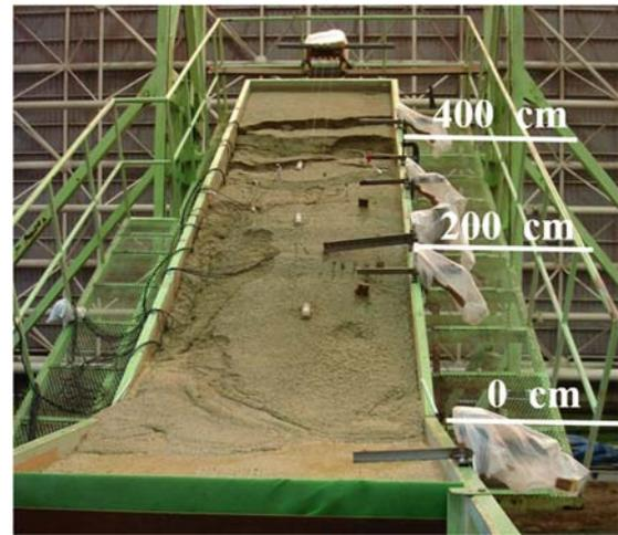
写真3 崩壊後の模型斜面（正面）
